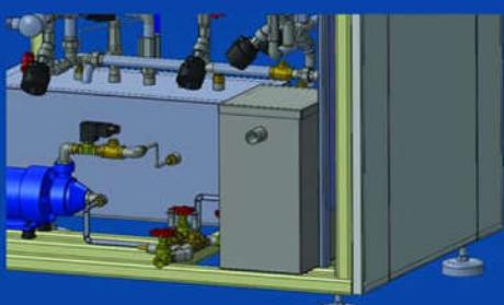
سیستم تولید بخار (مولد بخار) شامل مخزن تحت فشار، المونت ها، پمپ آب، سنسورهای سطح آب و سوییچ فشار می باشد. با استفاده از تبخیر آب مخزن بخار مطلوب تولید می شود
